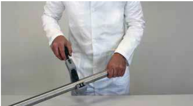
Řezání potrubí na délku
